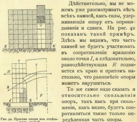
Рис. 42. Простая опора изъ отдельныхъ камней.
